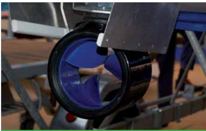
Der einziehbare Ringmotor an einem G2 Segelboot.
